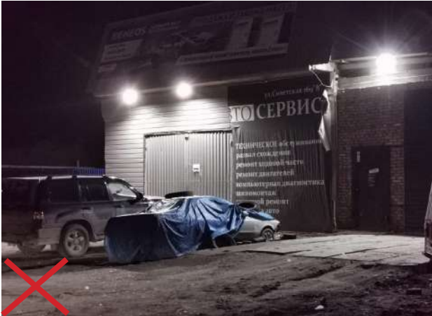
Недопустимо устанавливать светильники (прожекторы) со слепящим эффектом.
