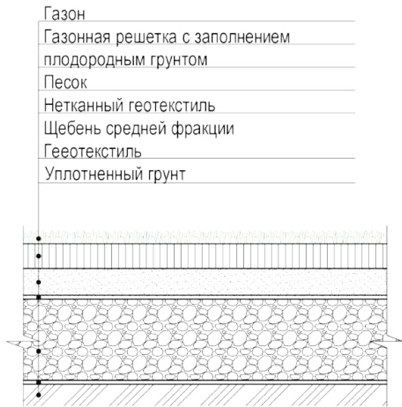
3.11 Схема устройства основания под укрепленный газон
