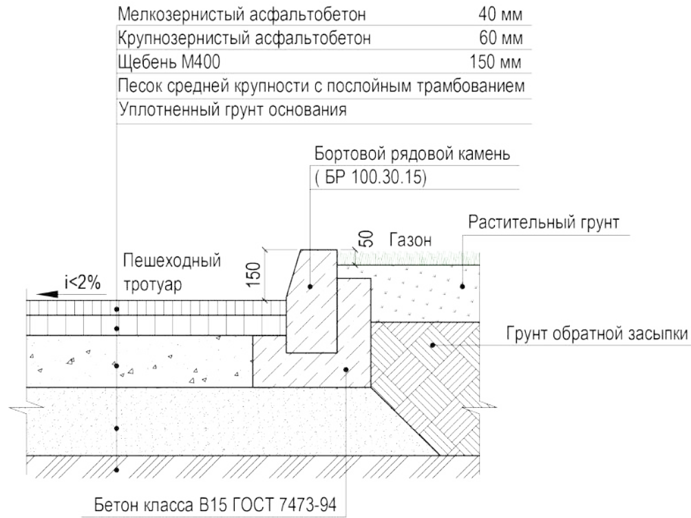
3.13.1 Схема устройства сопряжения асфальтобетонного покрытия и газона
